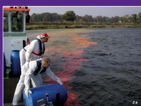
Abb. 2: Einleitung des Markierungsfarbstoffs Sulfurhodamin G in die Elbe a) bei Mauken, Tracerversuch im Abschnitt Mauken – Geesthacht b) bei Néměcice, Tracerversuch im Abschnitt Néměcice – Píra (BG)
