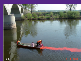
Abb. 2: Einleitung des Markierungsfarbstoffs Sulfurhodamin G in die Elbe a) bei Mauken, Tracerversuch im Abschnitt Mauken – Geesthacht b) bei Néměcice, Tracerversuch im Abschnitt Néměcice – Píra (BG)
